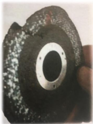
Bei Durchführung der geforderten Sicht- und Funktionsprüfung zu Beginn der Arbeit wäre ihm der deutliche Riss in der Trennscheibe mit Sicherheit aufgefallen. Die Trennscheibe war ablegereif und hätte ausgetauscht werden müssen. Mit einer neuen, funktionstüchtigen Trennscheibe wäre dieser Unfall nicht passiert.
